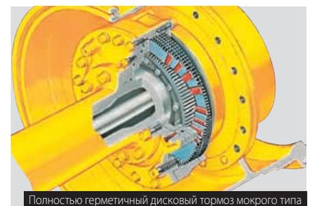
Полностью герметичный дисковый тормоз мокрого типа
