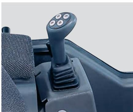
Автоматическая трансмиссия переключается (в ручном режиме) с помощью джойстика рулевого управления
